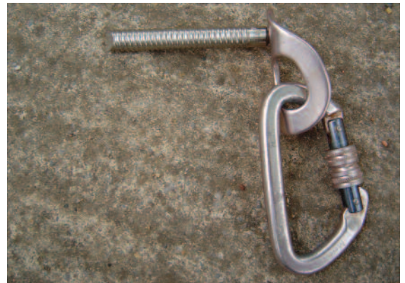
Douille Hilti avec amarrage en place
