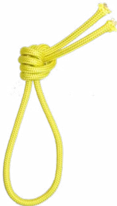
Figure 5: le nœud "roumain" est un nœud de plein poing présentant une excellente résistance statique, il est particulièrement utilisé avec des anneaux en kevlar pour concevoir des lunules lors des escalades dans les Dolomites. Ce nœud s'est avéré très difficile à défaire après une traction de 300 daN sur l'anneau.
