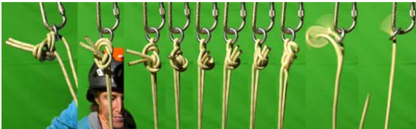
Figure 11: prise en charge de rappel brutale sur deux brins de corde aquaram reliés par un nœud de huit non serré.
