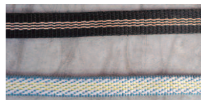
Sangle polyamide et sangle polyamide-dyneema avec filets de résistance
